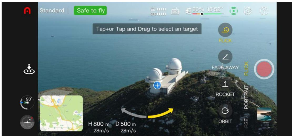
3. После выбора любого режима короткого нажмите «+» на объекте на экране или нажмите на объект пальцем. Затем нажмите на кнопку фото/видео, квадрокоптер автоматически взлетит, запишет видео и вернется в начальную точку после завершения съемки.
